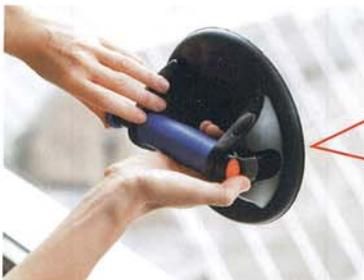
« Nous nous intéressons autant aux outils utilisés qu'aux techniques qu'ils engendrent. Cette ventouse permet de manipuler les panneaux lisses. C'est un objet séduisant pour lui-même, autonome et solidaire à la fois. »
